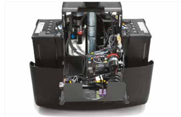
Accès facile pour un entretien efficace et batterie sans entretien
