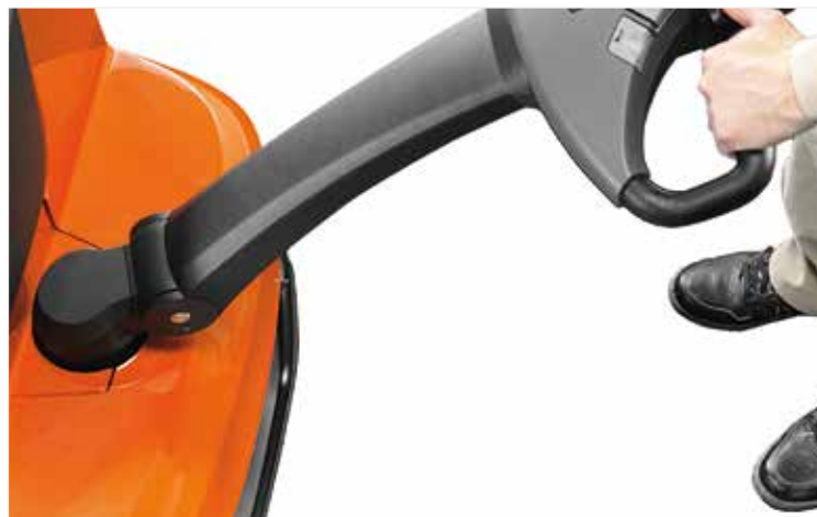
La longueur du timon a été calculée pour accroître la sécurité et éloigner les pieds du cariste du chariot
