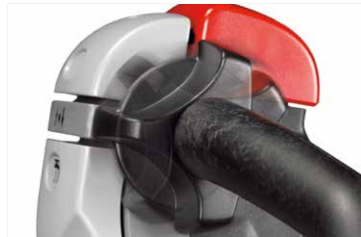
Poignée de commande ergonomique avec interrupteur de sécurité en position ventrale qui, pour que le cariste ne se retrouve pas coincé, déclenche une petite marche arrière rapide du chariot
