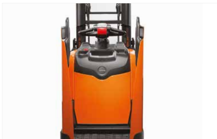
Protections latérales et système de direction E-man pour un déplacement confortable et sûr sur de longues distances
