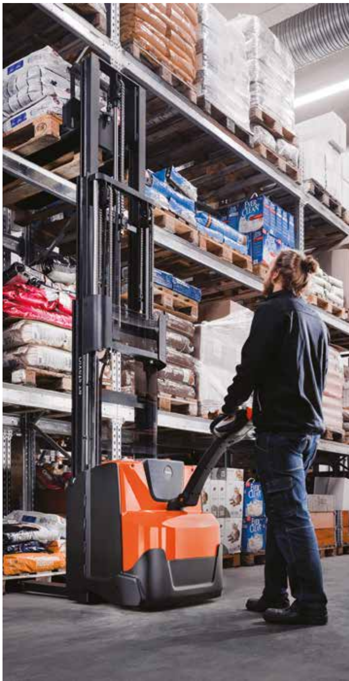
La longueur du timon a été calculée pour accroître la sécurité et éloigner les pieds du cariste du chariot
