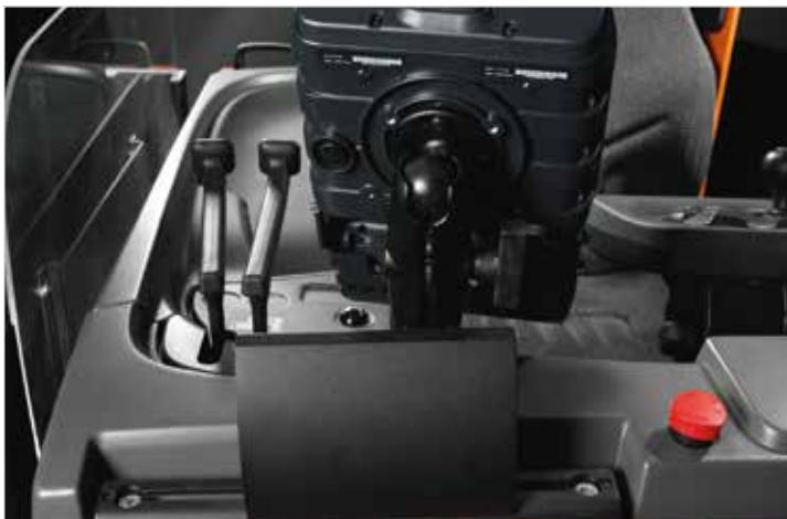
Le support universel E-bar permet de raccorder des équipements tels qu'ordinateurs, périphériques informatiques et lecteurs de codes barre
