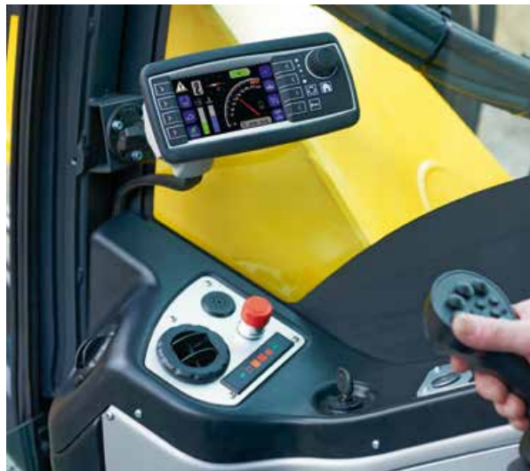
Joysticks, chacun à 28 fonctions proportionnelles et numériques, conçus spécialement pour la pelle araignée.
