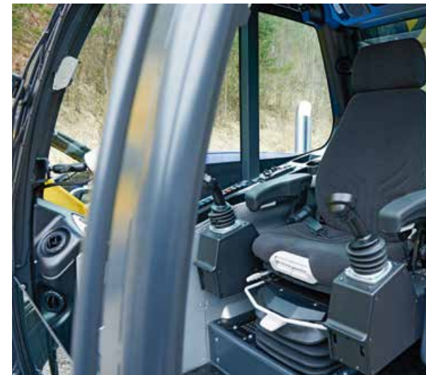
Siège ergonomique à suspension pneumatique, avec chauffage et suspension longitudinale.
