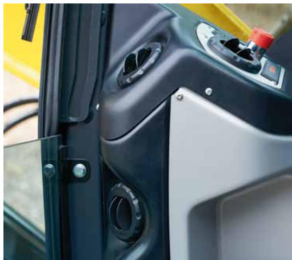
9 sorties d'air à l'intérieur de la cabine pour le chauffage et la climatisation.
