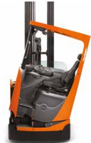
Ergonomie et sécurité renforcées avec la cabine inclinable : réduction des troubles musculo-squelettiques (par exemple tensions cervicales) du cariste et amélioration de la visibilité de la charge à grandes hauteurs
