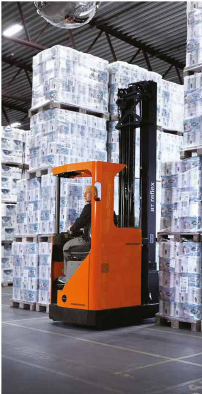
La fenêtre intégrée dans le montant arrière améliore la visibilité et la sécurité du cariste, car elle rend inutile tout mouvement hors du chariot
