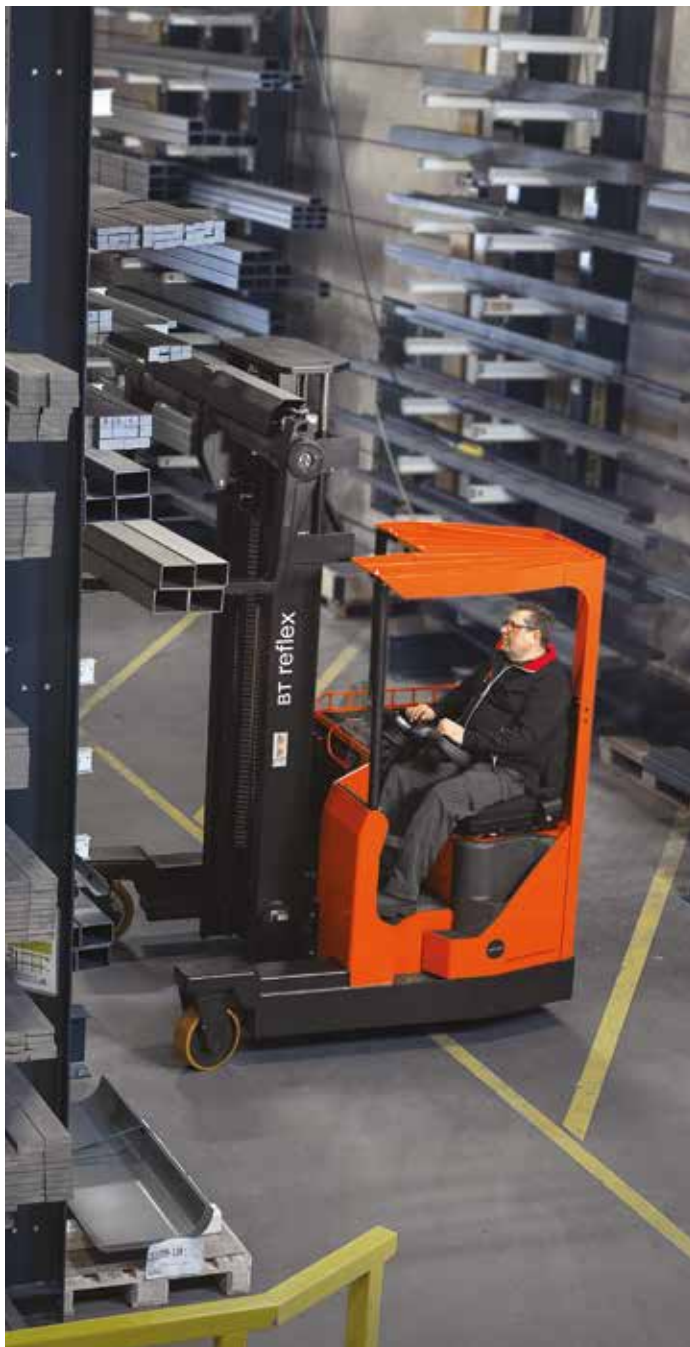
L'écarteur de fourches à commande hydraulique du BT Reflex série F permet d'adapter rapidement le chariot à des charges de dimensions variées
