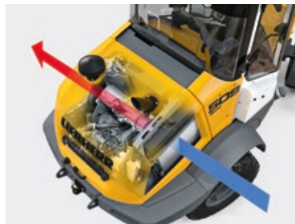
L'installation de réfrigération L 507/L 509
