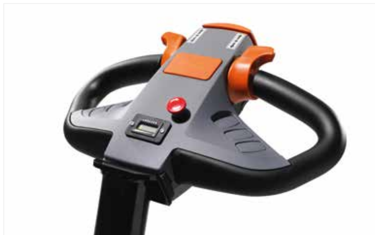
Le timon confortable et facile à utiliser affiche clairement l'état de la batterie
