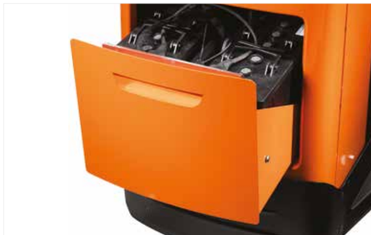
Remplacement rapide et facile de la batterie
