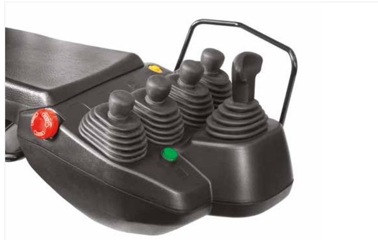
Les mini-levers intégrés dans l'accoudoir rendent l'utilisation du chariot simple et intuitive.
