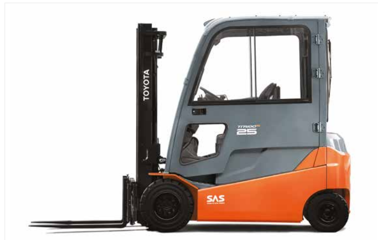
Les différentes cabines disponibles en option offrent une protection contre les intempéries ainsi qu'un confort et une sécurité accrus.
