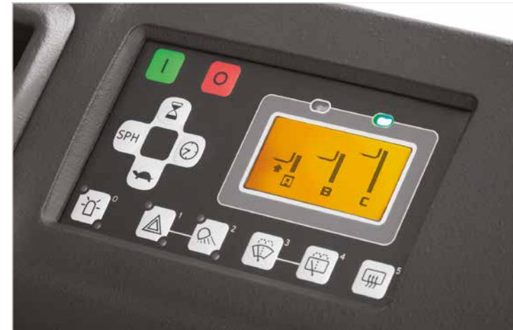
La fonction de présélection de hauteur économise du temps et de l'énergie.
