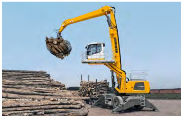
La LH 50 M Industry Litronic avec remorque pour la manutention de rondins de bois
