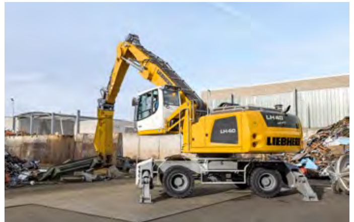
La LH 40 M Industry Litronic pour le désassemblage de poutres métalliques avec une cisaille ferraille
